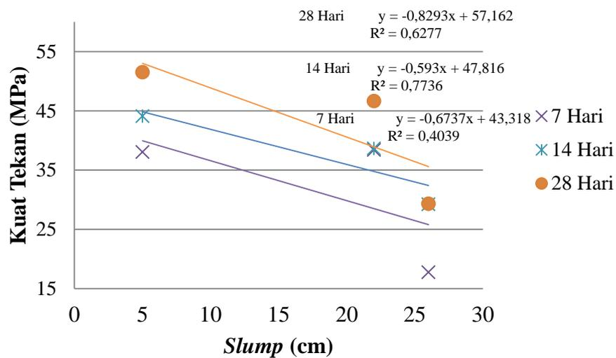
Gambar 5.2 Hubungan *slump* terhadap kuat tekan beton
