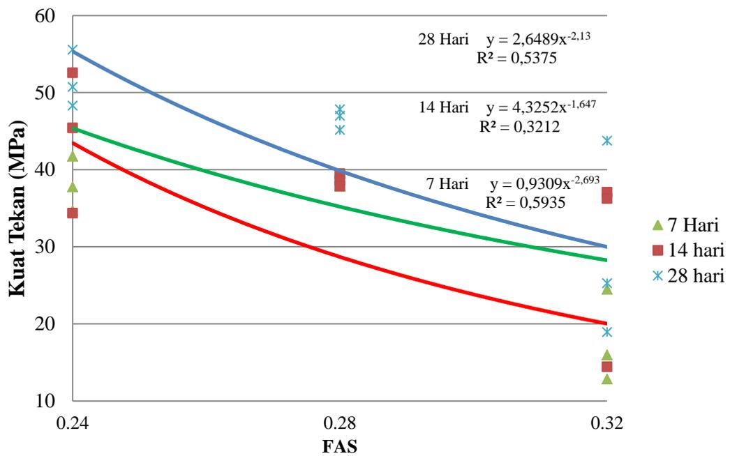
Gambar 5.3 Hubungan antara kuat tekan beton dengan FAS
