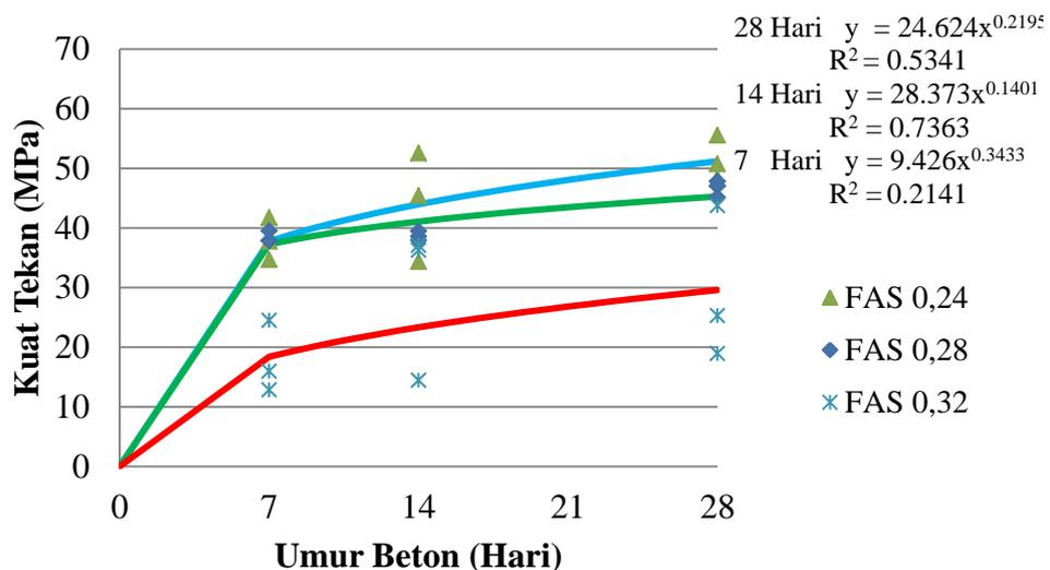
Gambar 5.4 Hubungan umur beton terhadap kuat tekan
