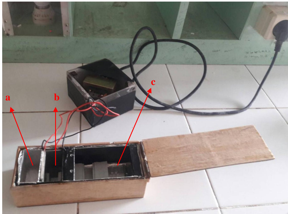
Gambar 3. Alat penstabil suhu ; a. Tabung air penstabil alat; b. Tabung air dingin; c. Tabung air panas
