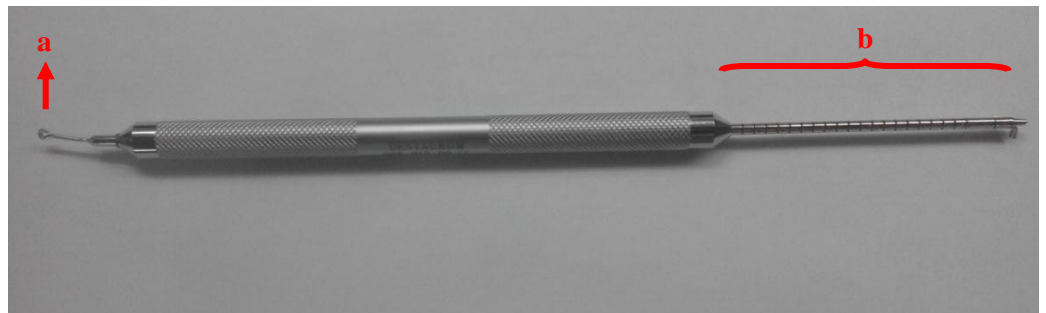
Gambar 2. Tension Gauge ; a. Kail pengait; b. Skala pengukuran
