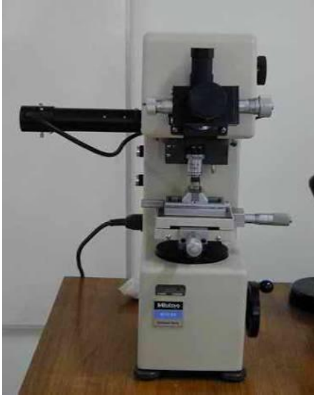
Alat uji kekerasan Vickers
