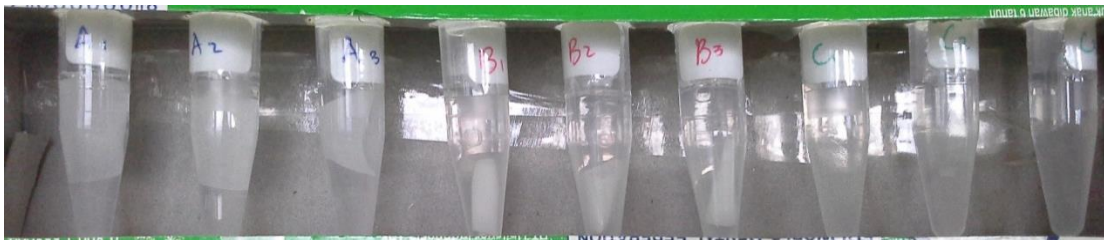
Keadaan seluruh sampel perancah ketika perendaman pada larutan PBS pH 7,4 dimulai.
