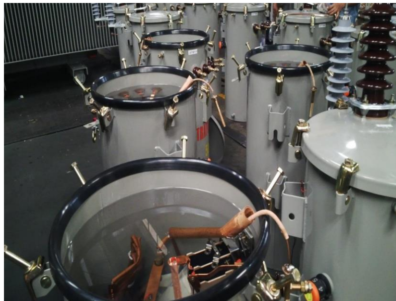
Gambar 2.14. Transformator Dengan Sistem Pendingin Minyak
