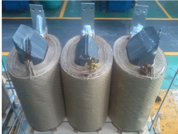
Gambar 2.8. Lilitan Transformator (Sumber: PT. TRAFONDO PRIMA PERKASA)
