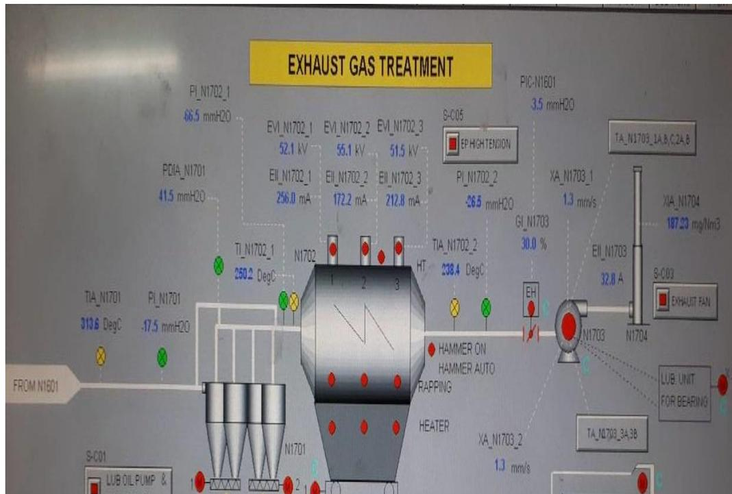
Gambar 4.3 Tampilan skema ESP RK-4
