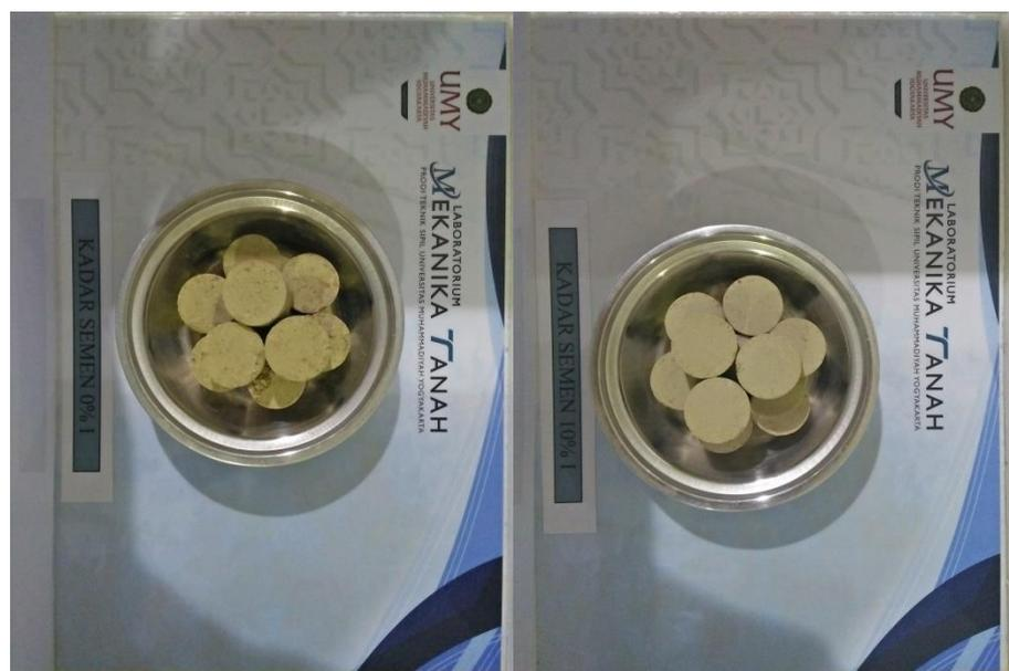
Gambar 3.13 Sampel Benda Uji Kadar semen 0% dan 10%
