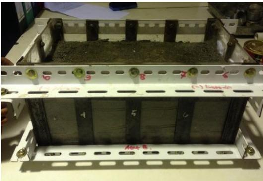
Gambar 2 Tanah yang dipadatkan dalam kotak uji
