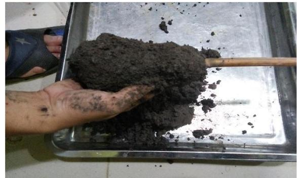
Gambar 21 Penggumpalan tanah pada ara disekitar katoda (-)
