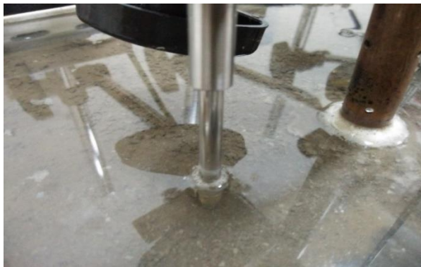
Gambar 21. Fenomena elektrolisis pada elektroda
