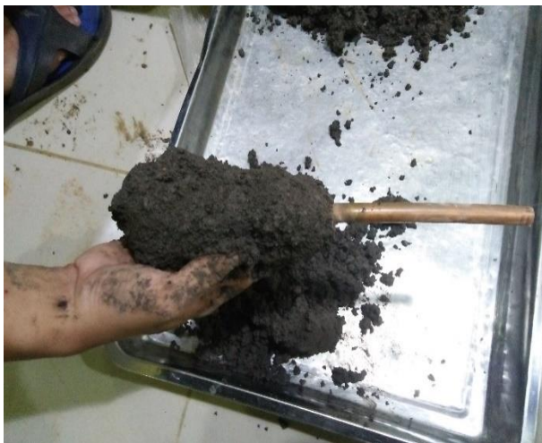
Gambar 28. Tanah pada katoda pasca pemberian elektrokinetik dan kolom kapur
