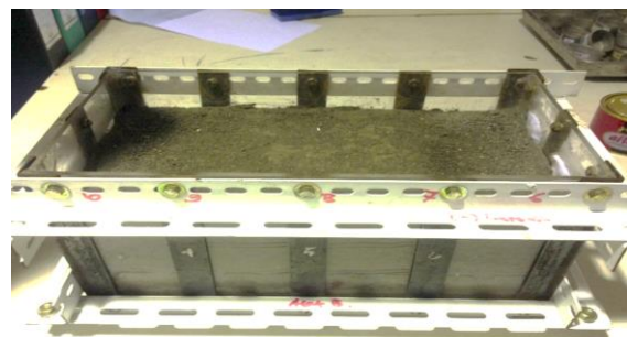
Gambar 2. Tanah yang dipadatkan dalam kotak
