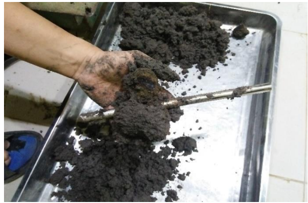
Gambar 29. Tanah pada anoda pasca pemberian elektrokinetik dan kolom kapur
