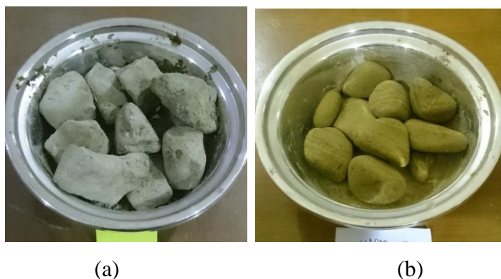
Gambar 4.6 Benda uji dengan semen 10% (a) kondisi awal dan (b) kondisi setelah siklus ke-5.
