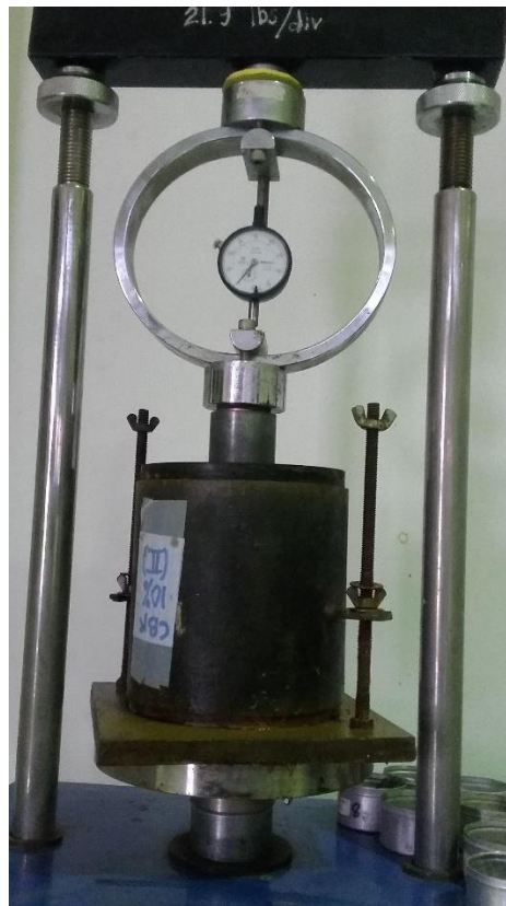
Gambar 3.17 Pengujian CBR Laboratorium
