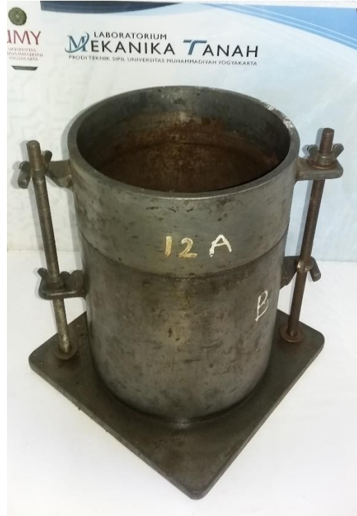
Gambar 3.5 Silinder pemadatan untuk pengujian CBR
