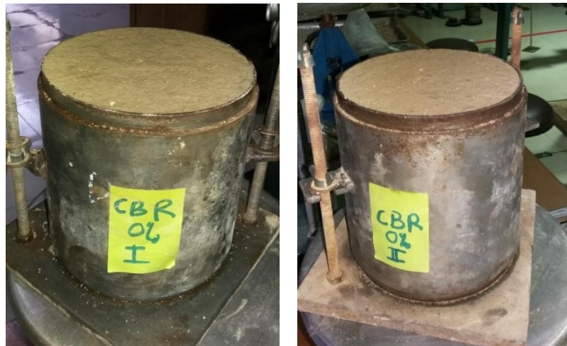
Gambar 3.14 Benda uji CBR laboratorium kadar semen 0% setelah dicetak
