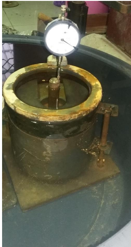
Gambar 3.16 Proses pengukuran pengembangan benda uji
