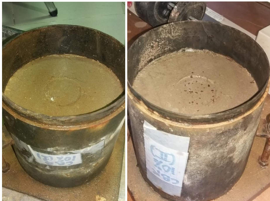
Gambar 4.5 Benda uji kadar semen 10% setelah penetrasi
