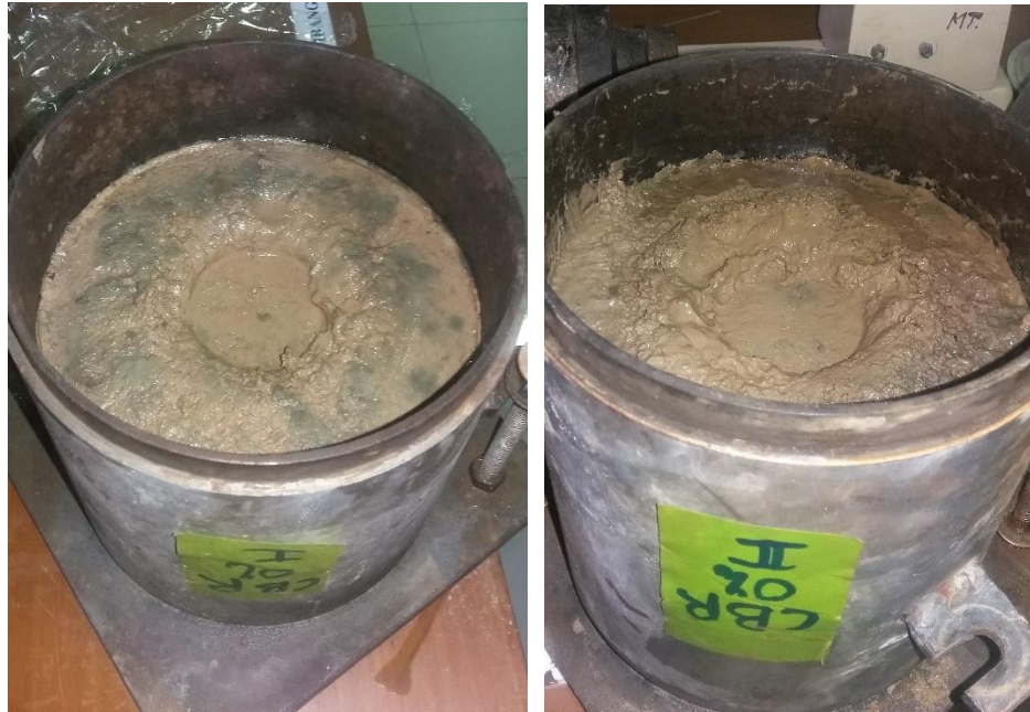
Gambar 4.4 Benda uji kadar semen 0% setelah penetrasi
