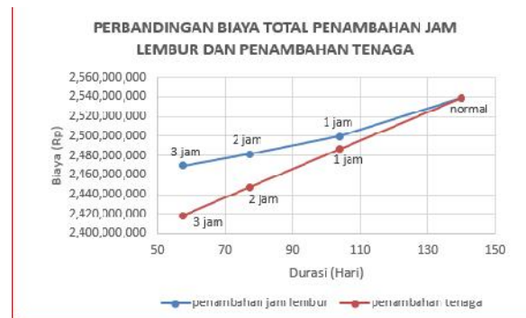
Gambar 8 Grafik perbandingan titik biaya normal dengan biaya penambahan jam lembur dan penambahan tenaga
