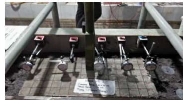
Gambar 2 Pemasangan dial gauge
