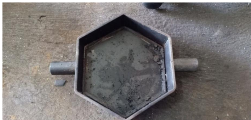
Gambar 3.7 Cetakan Paving Block Prisma Segi 6 Yang Sudah Jadi
