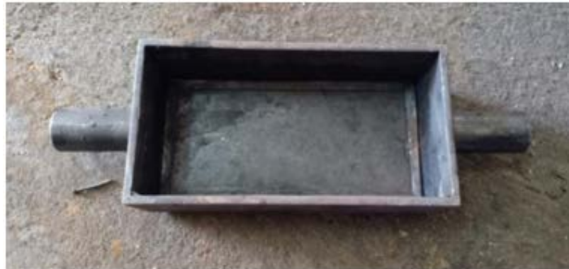
Gambar 3.6 Cetakan Paving Block Balok Yang Sudah Jadi
