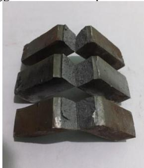
Gambar 8 patahan spesimen uji impact menggunakan cetakan pasir kering.
