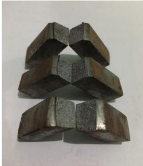
Gambar 7 patahan spesimen uji impact menggunakan cetakan pasir basah.
