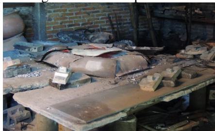
Gambar:4.11 Tungku peleburan Setelah pemanasan, logam aluminium cair dituangkan melalui saluran masuk ke
