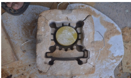
Gambar: 4.9 Pola yang sudah dirakit PELEBURAN DAN PENUANGAN
