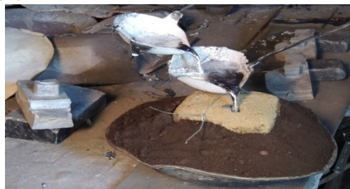
Gambar: 4.13 Penuangan logam cair kedalam cetakan
