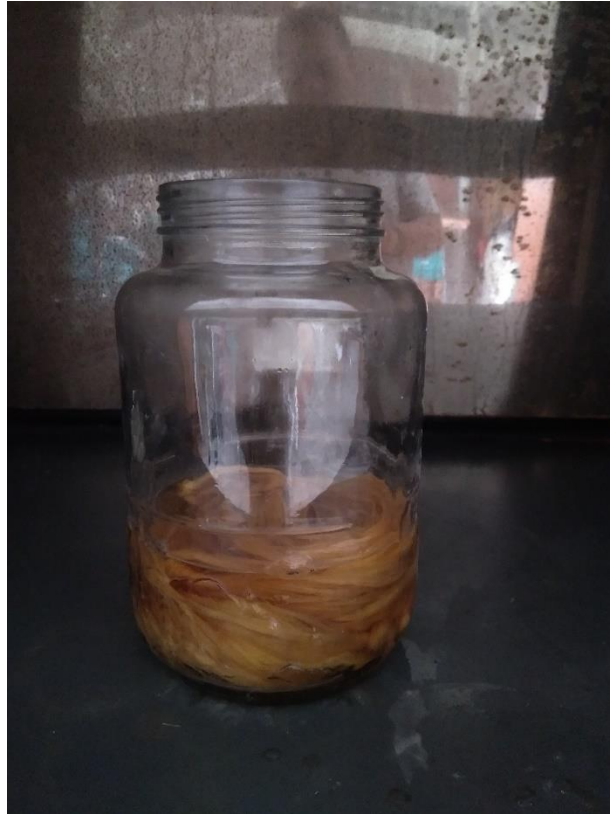
Gambar 3.15 Proses Netralisir NaOH pada serat
