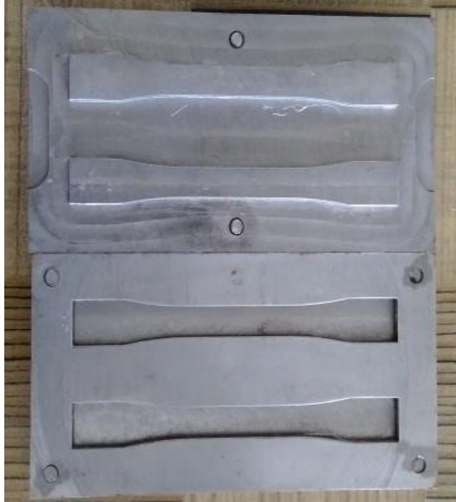
Gambar 3.5 Cetakan Pengujian Tarik ASTM D638-01
