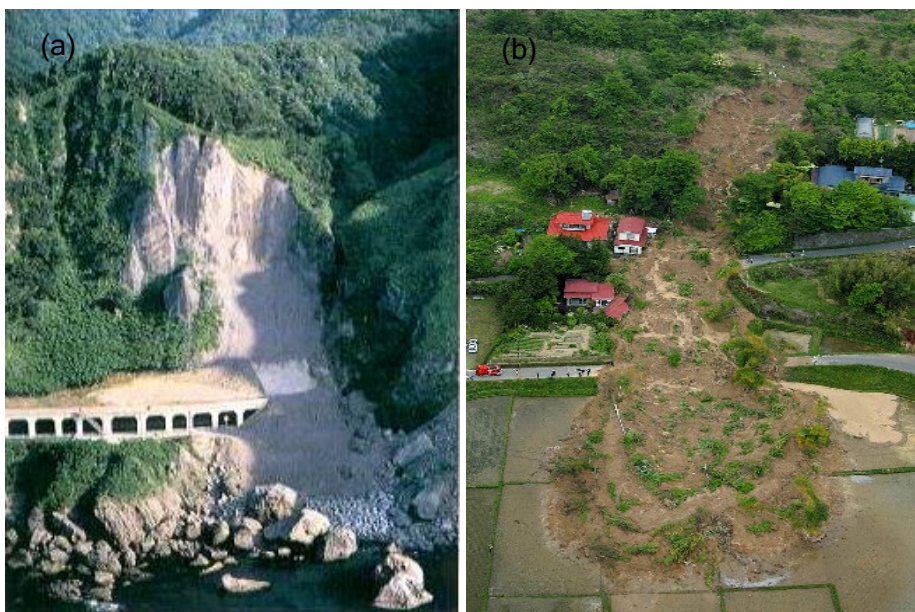
Gambar 1.8 Kejadian longsor akibat gempa bumi: (a) jenis runtuh batuan di Raiden Kaigan, Katanakake Iwanai-Cho, Hokkaido, (b) longsor aliran lumpur di Tsukidate, Tohoku.
