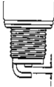
Gambar 2.16. Mengukur celah busi (Sumber : Prabowo, 2005)
