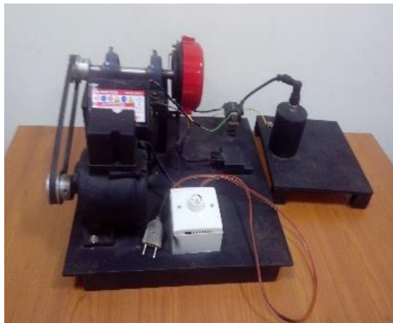
Gambar 3.11. Alat penguji percikan bunga api pada busi
