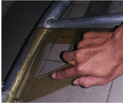
Gambar 4.8. Penyesuaian Sudut Pada Rangka Utama
