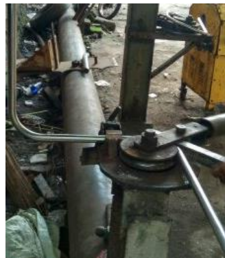
Gambar 4.25. Pengerolan Dudukan Mesin
