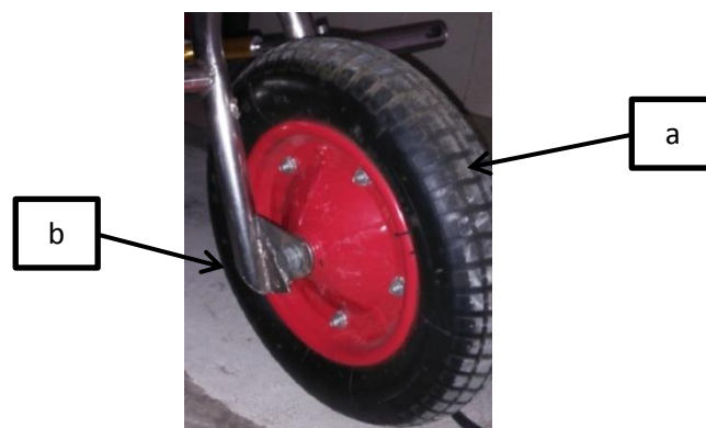
Gambar 4.37. Perakitan Roda Depan
