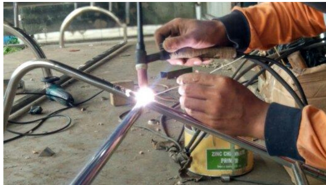
Gambar 4.27. Pengelasan Dudukan Mesin
