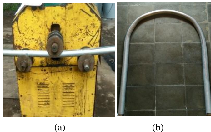
Gambar 4.6. (a) Proses Pengerolan (b) Bahan Seteleah Dirol Berbentuk U
