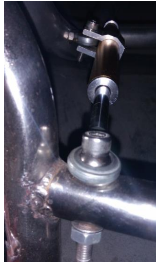
Gambar 4.47. Pemasangan Mur dan Baut Stabilizer
