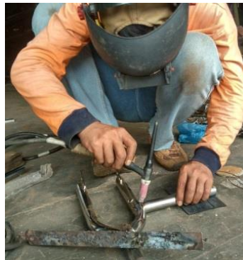
Gambar 4.15. Proses Pengelasan Fork Roda
