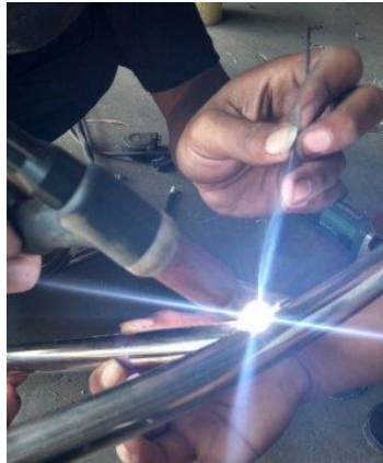
Gambar 4.29. Pengelasan Frame Lingkaran
