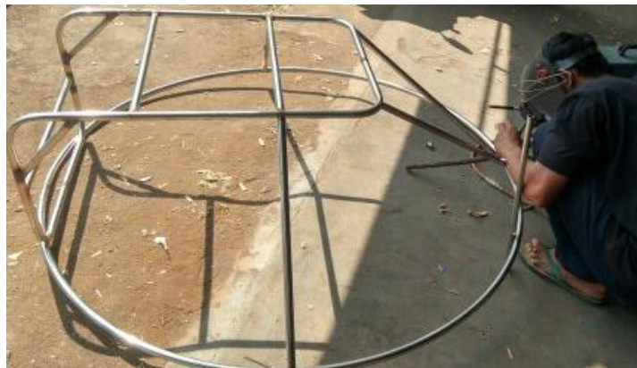
Gambar 4.30. Pengelasan Seluruh Bagian Propeller Frame
