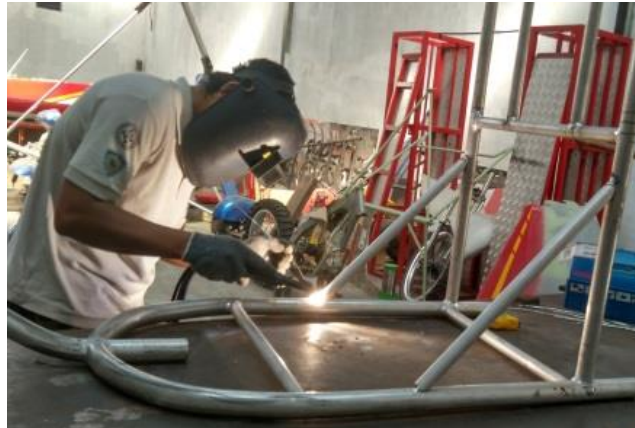
Gambar 4.10. Pengelasan Rangka Utama
