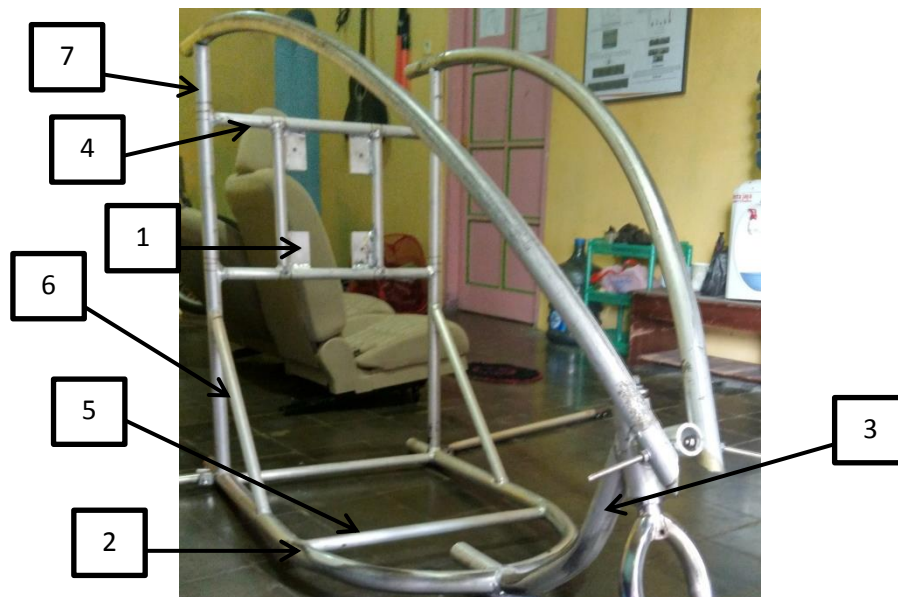
Gambar 4.2. Desain Rangka Utama
