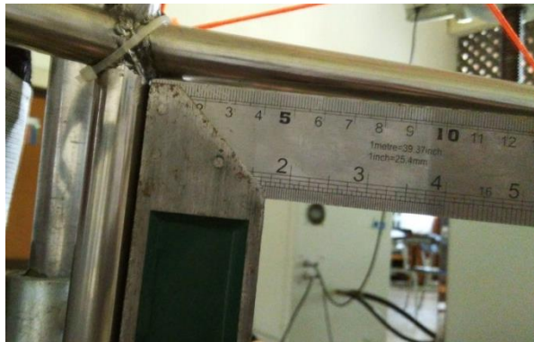
Gambar 4.28. Penyesuaian Sudut Pada Frame Lingkaran
