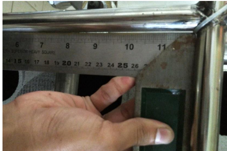
Gambar 4.14. Penyesuaian Sudut Pada Fork Roda
