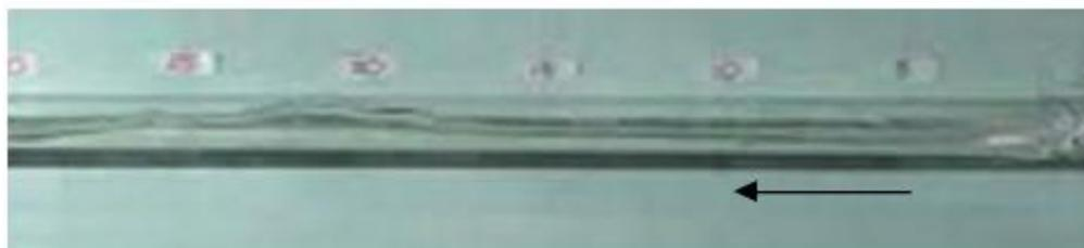
Gambar 2.11. Fenomena gradien tekanan untuk  $Q_{uap} = 0,005456701 \text{ m}^3/\text{s}$  pada detik ke-6 (*wavy*) (Sukamta dkk, 2010)
