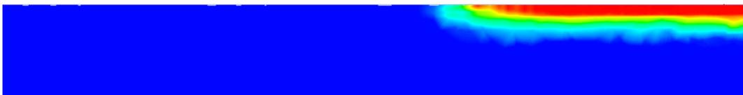
c) Pola aliran air-udara dengan  $J_G = 0,05$  m/s pada detik ke 0,9
